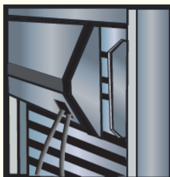
5. Finalizada a limpeza, posicione a tampa e encaixe-a na posição original.
